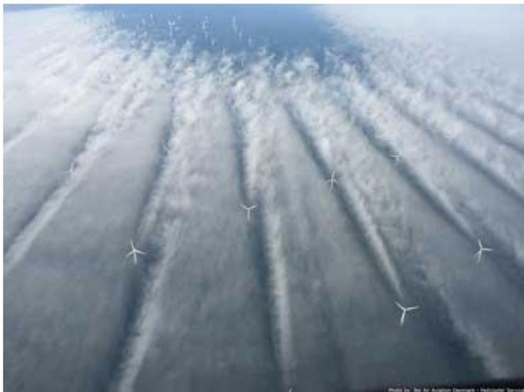
**Névoa baixa mostra detalhes surpreendentes do rastro de turbulência deixado **após** passarem pelas turbinas, no parque eólico *offshore*, Horns Rev, Dinamarca. Fonte:GOOGLE/DONG Energy**
