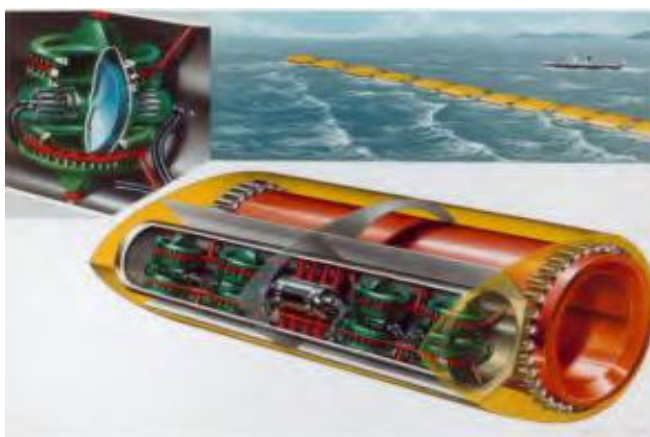
Imagem 4: Vista de um flutuador de produção de eletricidade de ondas - Sistema Salter's Cam
