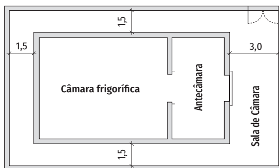
Figura 39 Esquema: afastamento mínimo na área externa da câmara fria
