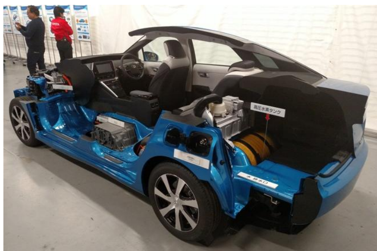
Os tanques com hidrogênio ficam debaixo do banco traseiro e no fundo do porta-malas.
